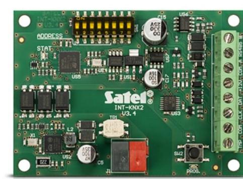
Il modulo INT-KNX-2 consente di controllare gli attuatori del sistema KNX mediante la centrale d'allarme e di riceverne i feedback. INT-KNX-2 è dotato di una connettore dedicato attraverso cui si collega direttamente al bus KNX. Le impostazioni del modulo sono configurabili attraverso il programma DLOADX.
